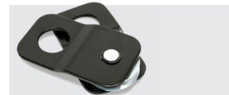
REF : 151 POULIE DE MOUFLAGE • Permet de dévier la force et de la répartir afin de doubler la force de traction d'un treuil. • Capacité charge max : 4000 kg • Diamètre de la poulie : 64 mm
